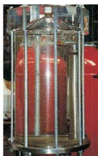
Bild 10: statische Vakuum-entgasung im „ruhenden Vakuum“
