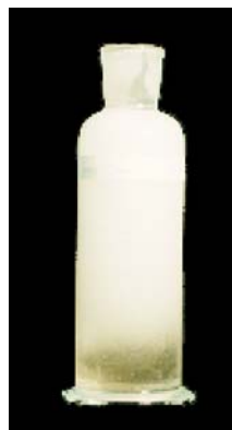
Bild 2: stickstoffübersättigtes, Heizungswasser nach der Probenahme
