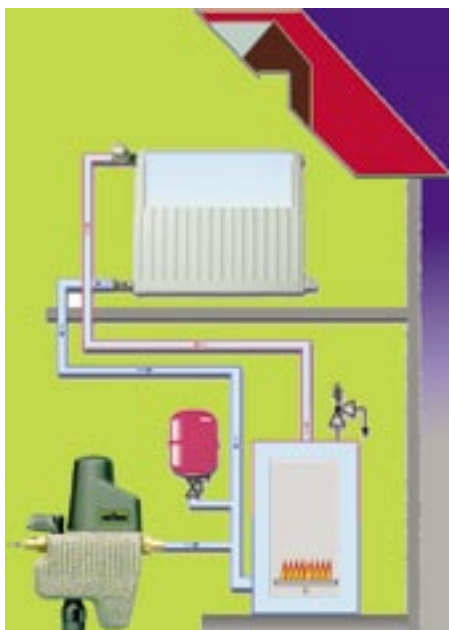
Bild 5 Einbau des Nachspeisesystems „Fillcontrol“ in die Heizungsanlage
