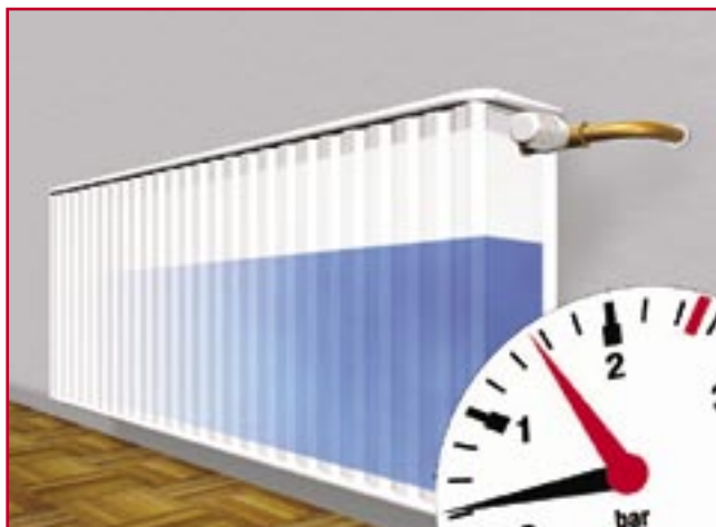
Bild 1 Das Absinken des Anlagendrucks begünstigt das Einsaugen von Luft an Heizungskörpern
